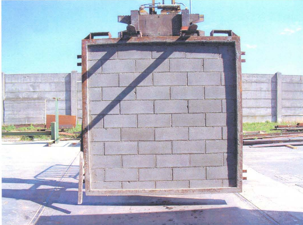
Foto 1. Lato esposto al fuoco del manufatto prima della prova
