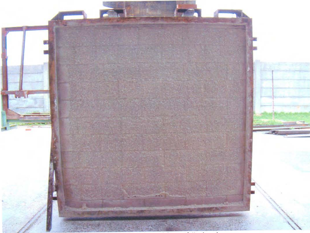
Foto 3. Lato esposto al fuoco del manufatto dopo la prova
